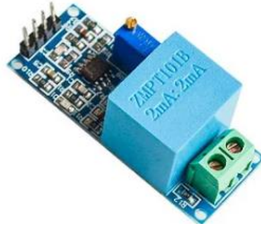
Figura 14 — Sensor de Tensão AC 0 a 250V Voltímetro ZMPT101B
