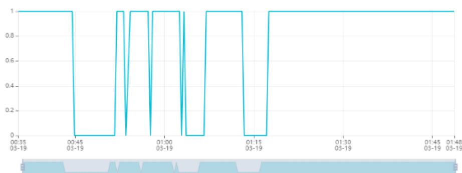
Figura 57 — Variável da boia física ligada a ESP32
