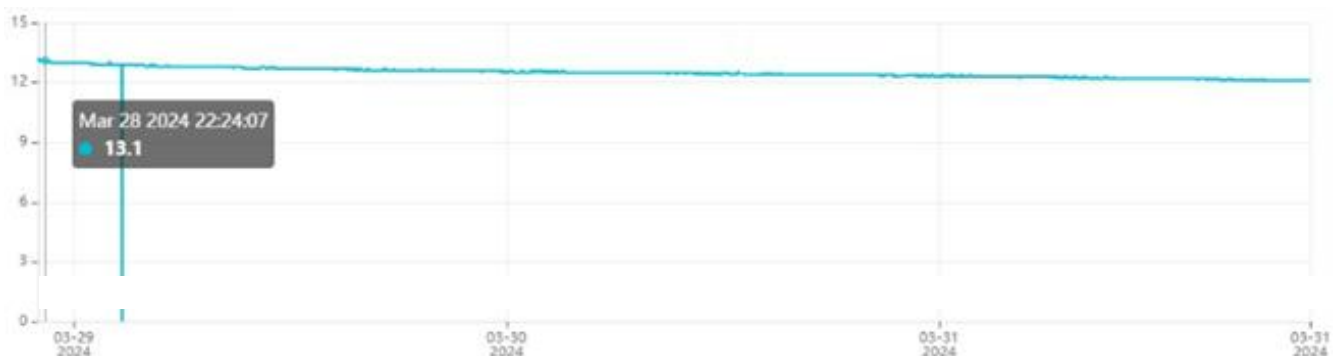
Figura 67 — Resultado da autonomia de 60 horas da bateria
