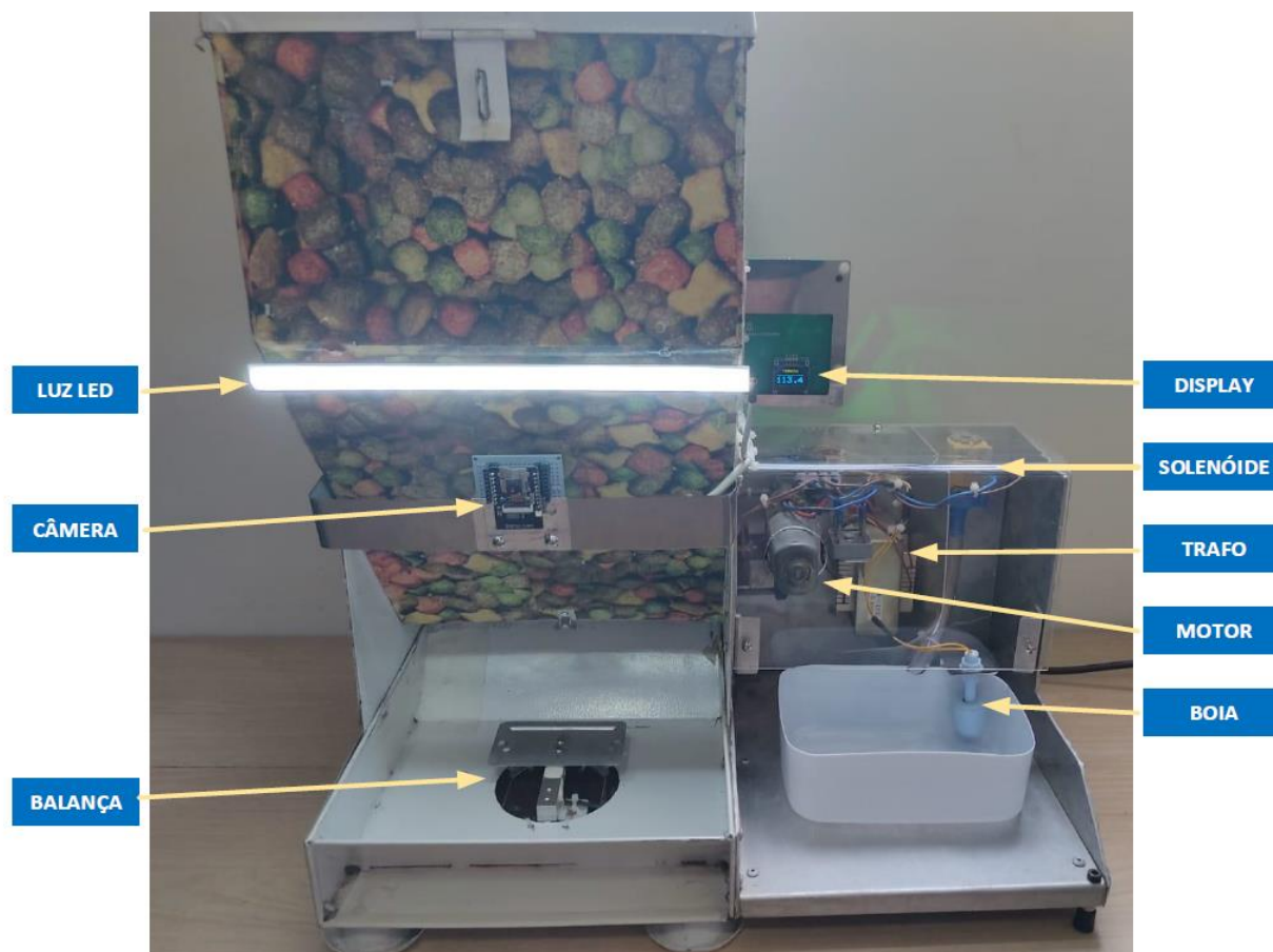
Figura 4 — Detalhes da estrutura
