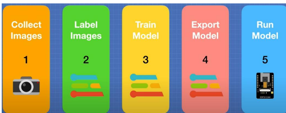
Figura 24 — Passos do treinamento da rede neural na plataforma Edge Impulse .
