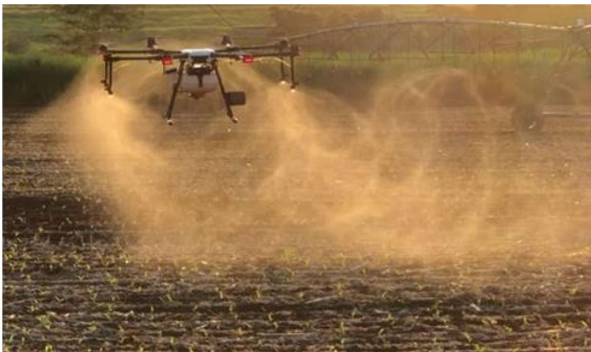
Figura 4 – Aplicação de diferentes formulações de feromônio líquido na cultura do milho com a utilização de um Drone (pulverizador octacóptero DJI Agras MG - 1). Ilha Solteira/SP.
