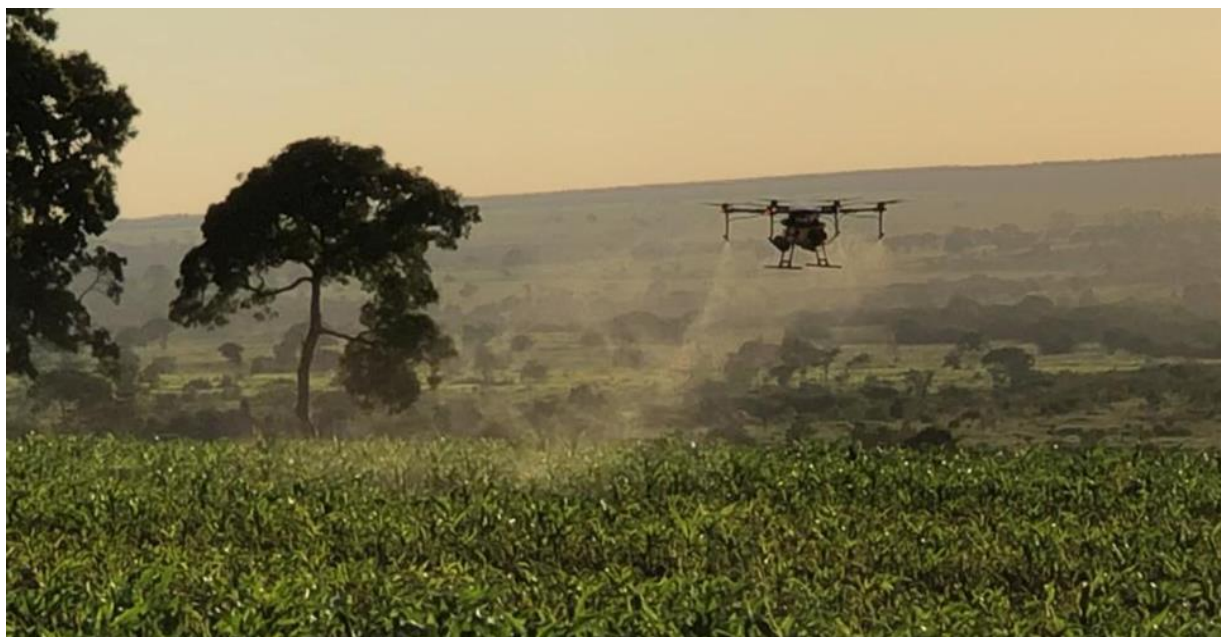
Figura 7 – Aplicação de diferentes formulações de feromônio líquido na cultura do milho com a utilização de um Drone (pulverizador octacóptero DJI Agras MG - 1). Selvíria/MS. 2020
