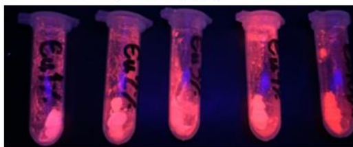
Figura 7: Fotografias de compostos dopados com 1%, 2%, 3%, 4% e 100% de Európio respectivamente e excitados por uma lâmpada UV (comprimento de onda próximo de 375 nm) (VERRUMA, 2020)
