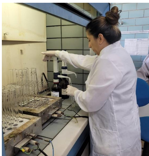
Figura 14 – Digestão sulfúrica das amostras para a realização da destilação pelo método Kjeldahl.
