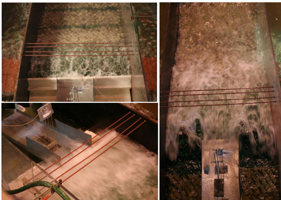
Figura 30 – Modelo Físico com escala 1:60 executado no LNEC.
