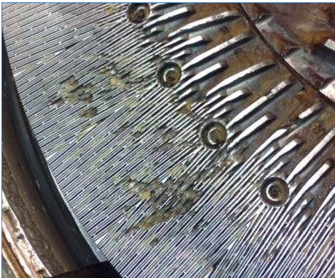
Figura 17 – Foto com as ranhuras no disco da máquina.
