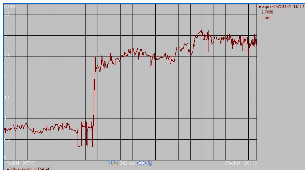
Figura 16 – Gráfico da variação da vibração da máquina.
