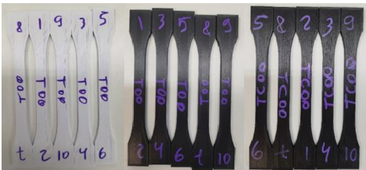
Figura 11 – Corpos de prova impressos para o ensaio de tração.
