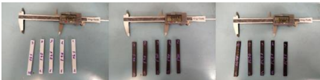
Figura 30 – Corpos de prova de PLA com orientação 90°.
