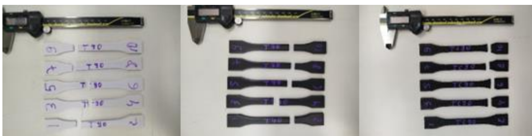
Figura 15 – Corpos de prova com orientação 90° após a fratura.
