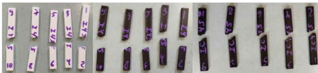
Figura 29 – Corpos de prova com orientação 45° após a fratura.
