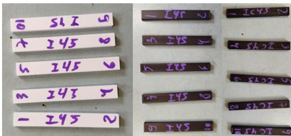
Figura 12 – Corpos de prova impressos para o ensaio de impacto.
