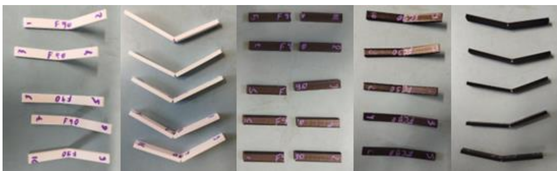
Figura 31 – Corpos de prova de PLA com orientação 90° após a fratura.
