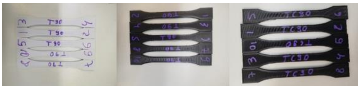
Figura 14 – Corpos de prova com orientação 90°.
