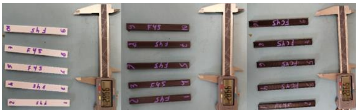
Figura 13 – Corpos de prova impressos para o ensaio de flexão.
