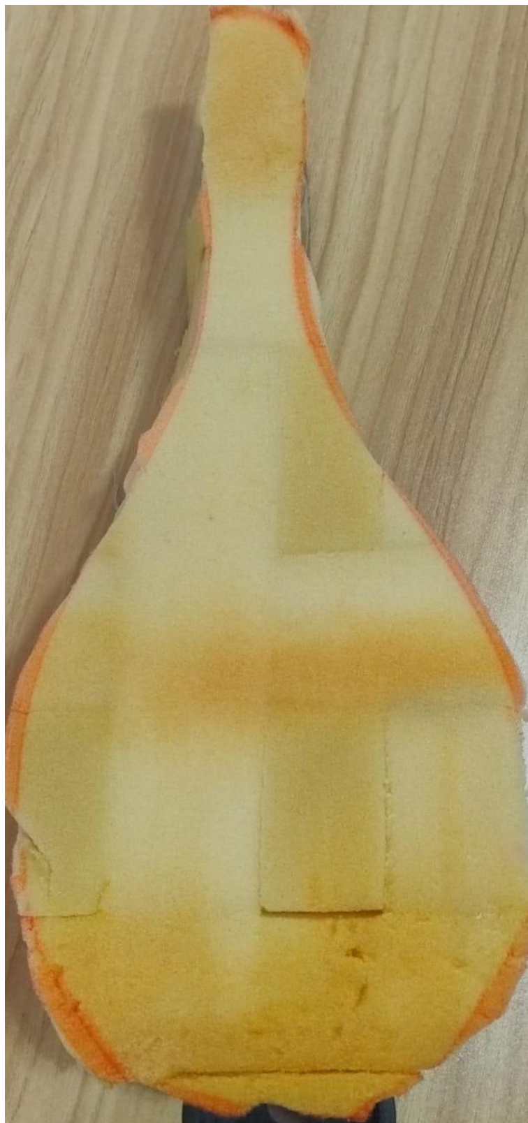
Figura 33 – Espuma recortada no formato de raquete e colada no papelão com cola quente
