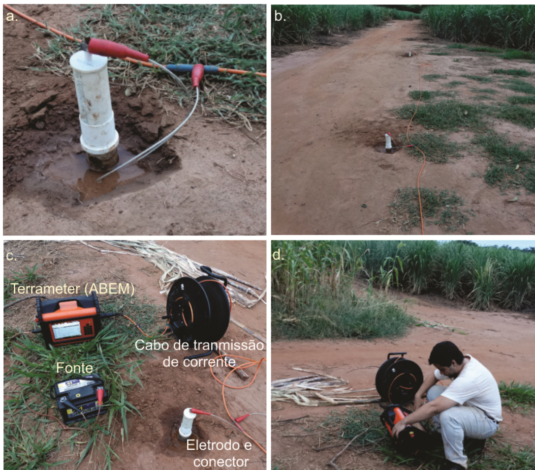
Figura 6. 2 – Etapas de preparação do ensaio geofísico: a. fixação do eletrodo, b. montagem do cabo de transmissão, c. conexão do resistivímetro e d. início da leitura de dados.
