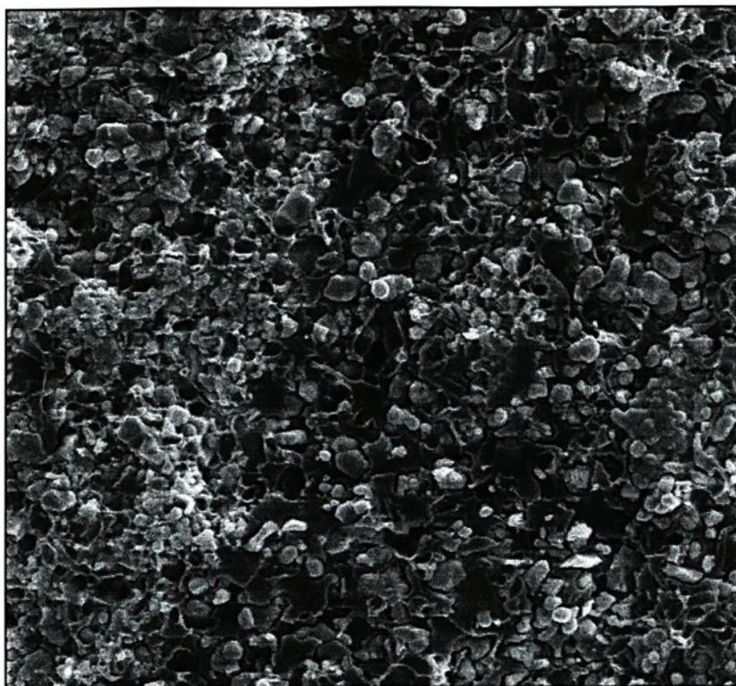
Figura 43- Fotografia (MEV) do compósito PZT/PU:26/74 (volume) com aumento de 2000x
