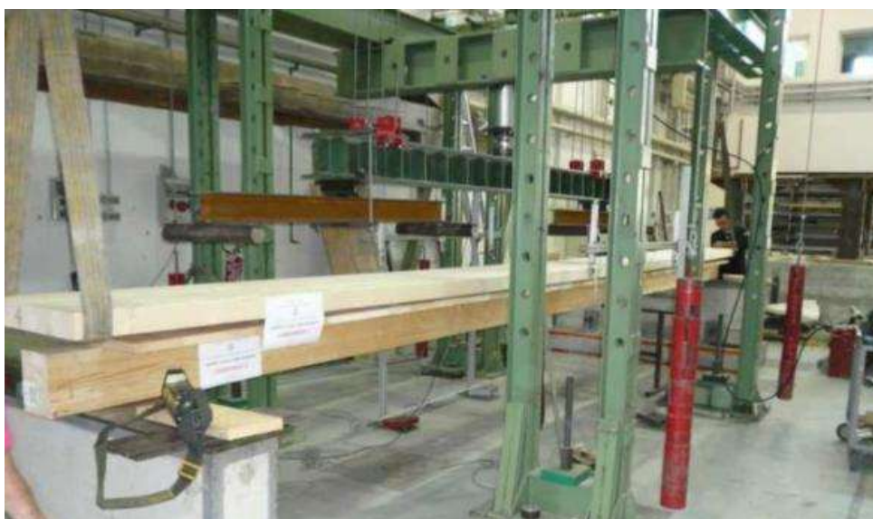
Figura 11 – Ensaio de flexão modelo de referência.
