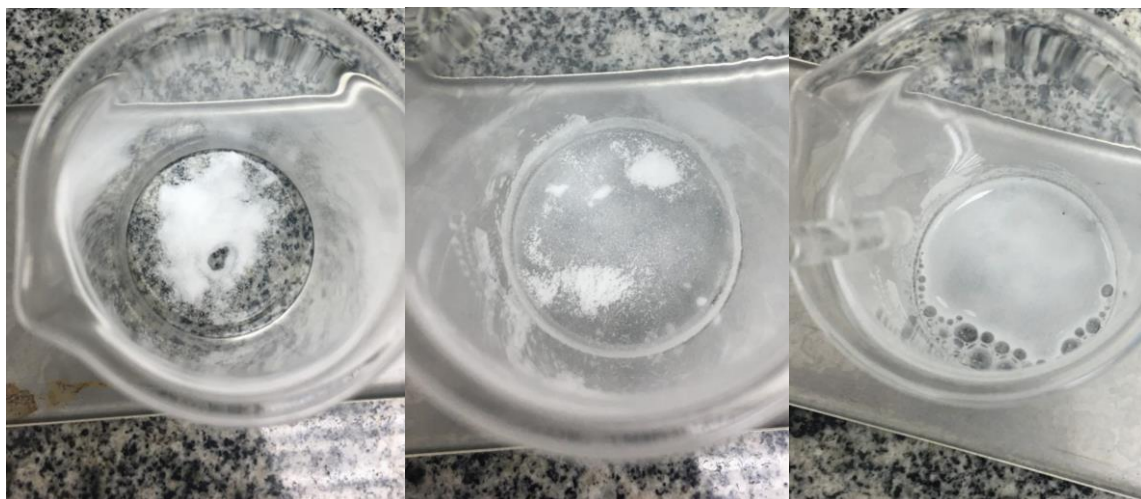
Figura 5 – PEAD com surfactante: seco (à esquerda), com água sem agitação (centro), com água após agitação (à direita)
