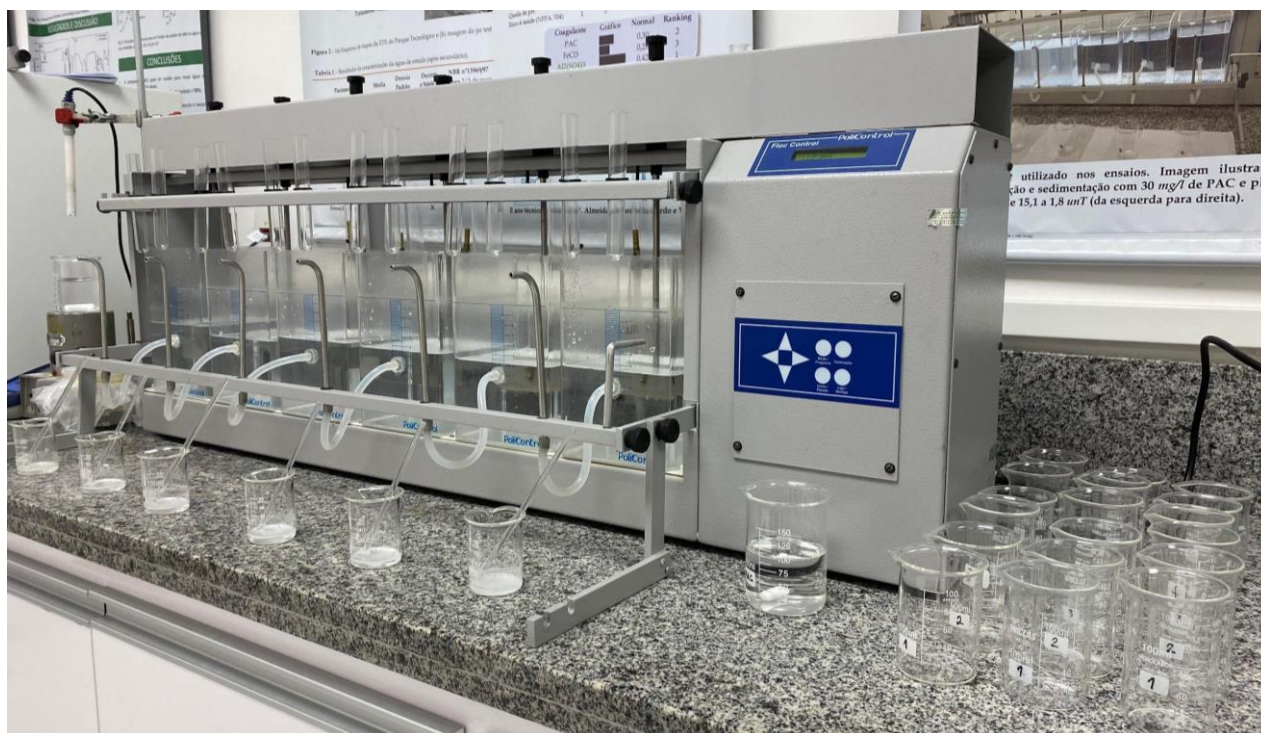
Figura 6 – Jar Test preparado para início do experimento
