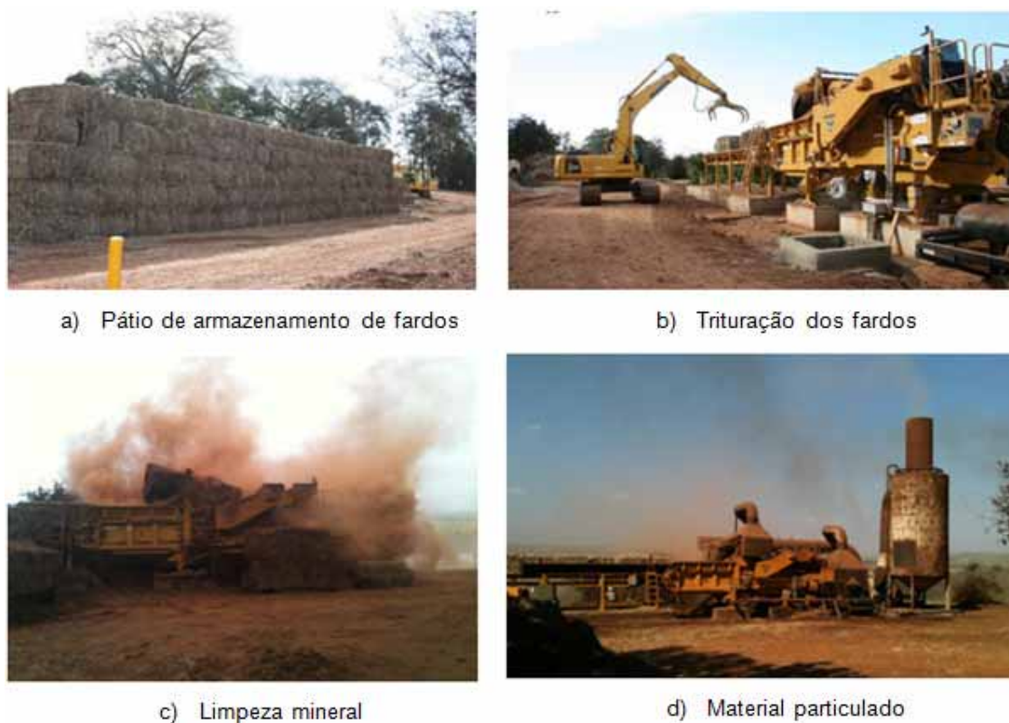
Figura 20 - Processo de utilização de fardos de palha na indústria.
