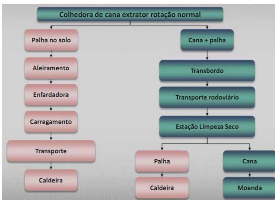
Figura 18 - Fluxograma de aproveitamento da palha da cana-de-açúcar.
