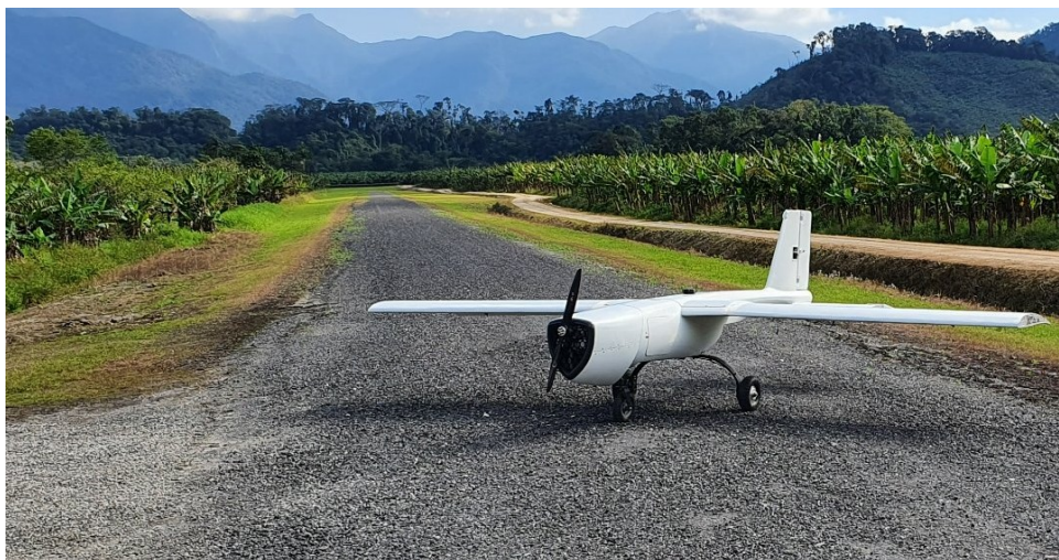
Figura 5 – VANT de pulverização agrícola SV-60 - AgroAviation.
