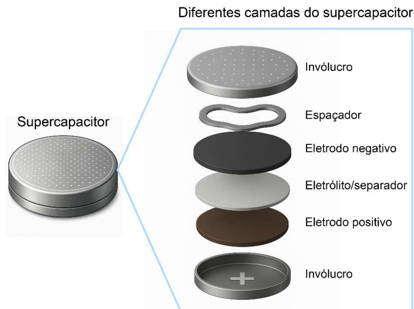
Figura 4. Esquema ilustrativo dos componentes utilizados para a montagem de um SC. Adaptado de [26].
