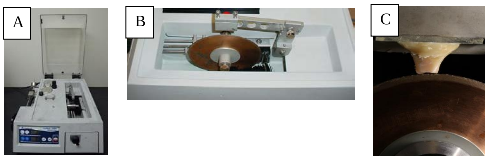
Figura 2: Confecção dos palitos em cortadeira de precisão. A= Cortadeira de precisão Isomet 1000; B= Disco diamantado acoplado; C= Conjunto amostra-disco diamantado.
