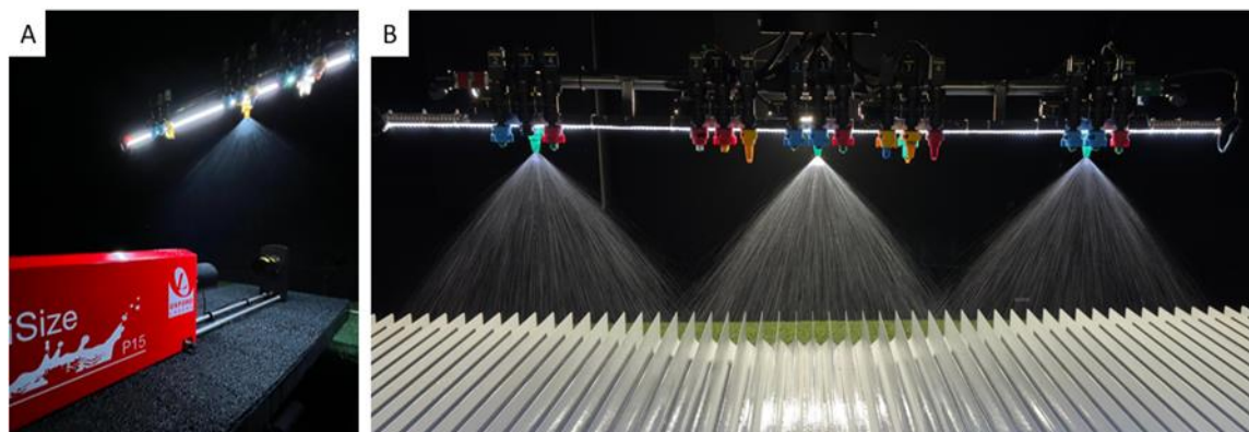
Figura 3 – Leitura do diâmetro volumétrico das gotas (A) e pulverização nas canaletas para perfil de distribuição volumétrica (B) (Silva, 2025).
