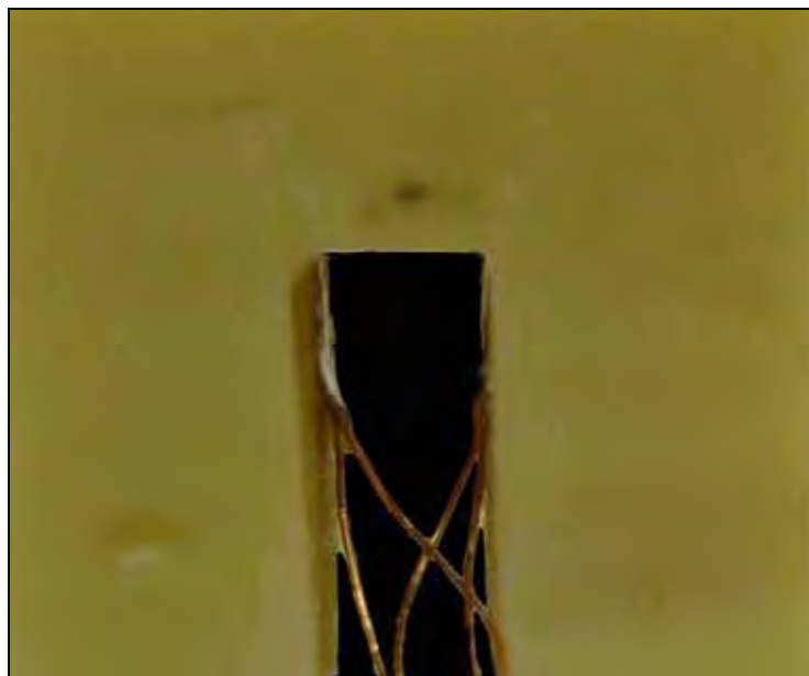
FIGURA 5 – Strain gauges colados tangenciando a parede de fundo da matriz de poliuretano.
