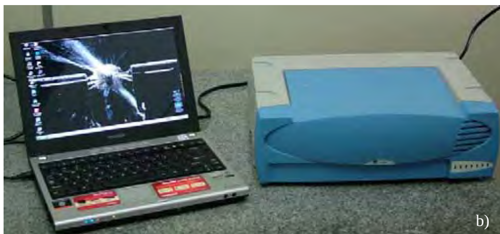
FIGURA 13 – a) Amplificador de sinais ADS 2000 IP (Lynxx São Paulo – Brasil); b) Microcomputador ligado ao amplificador de sinais.
