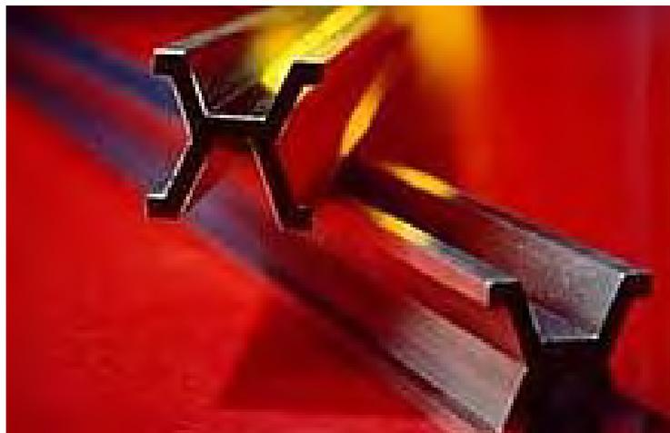
Figura 3: A barra de platina-irídio utilizada como prototipo do metro de 1889 a 1960.
