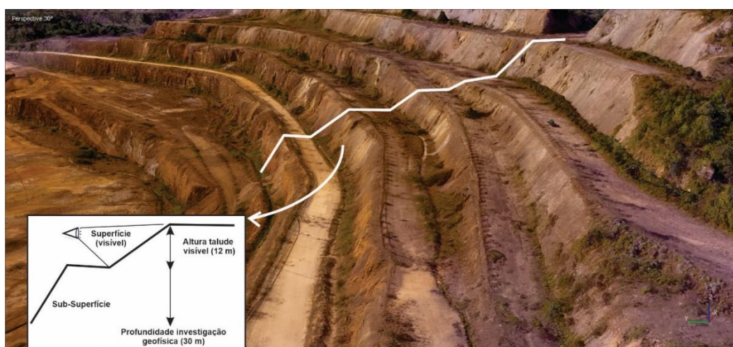
Figura 95: Esquema representativo da interpretação dos resultados do modelo de resistividade elétrica e cargabilidade
