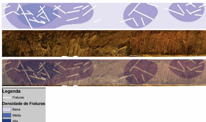
Figura 62: Densidade de Fraturas na face do Setor B
