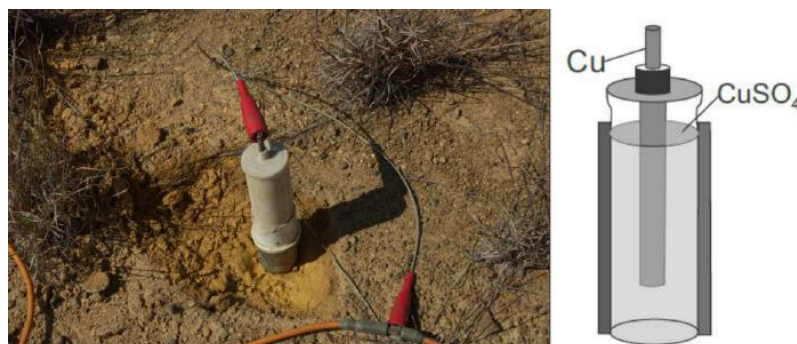
Figura 39: Eletrodo não polarizável utilizado no estudo
