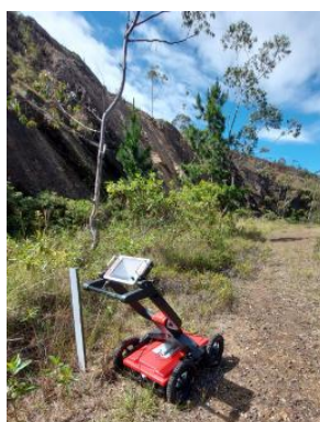
Figura 48: Equipamento GPR utilizado no ponto inicial de coleta de dados
