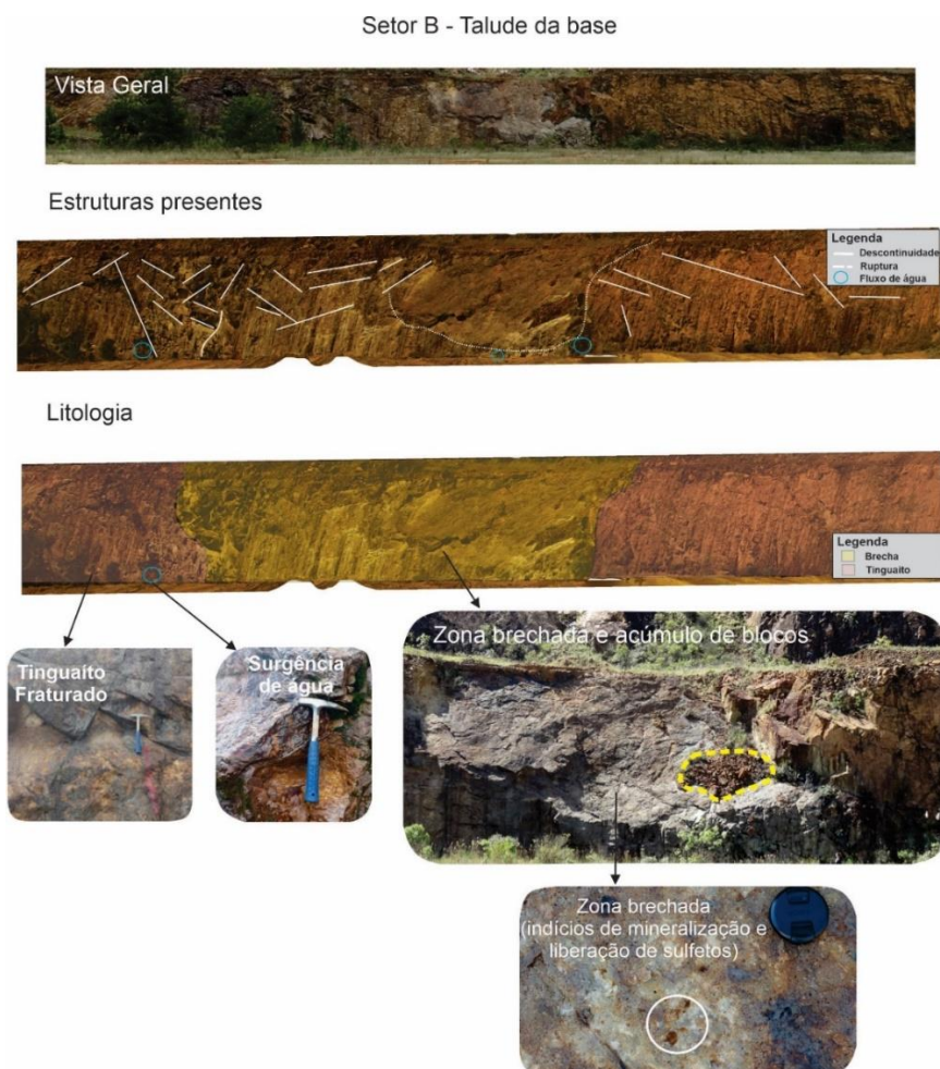
Figura 60: Litologia e estruturas presentes no Setor B. Blocos soltos na ruptura principal, evidências de percolação de água ao fim do plano de ruptura e resquícios de mineralização
