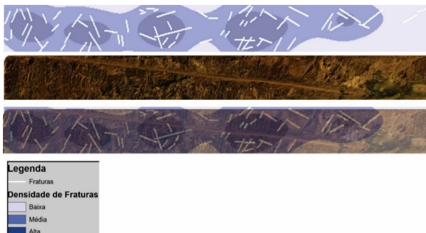
Figura 55: Densidade de Fraturas na face do Setor A
