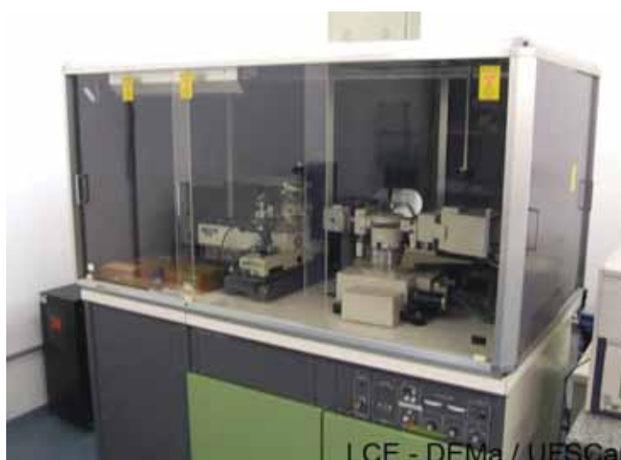
Figura 11-Equipamento utilizado para a análise de difração de raio-x.
