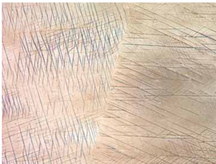
Figura 21- Estrutura da amostra resfriada dentro do forno no aumento de 100x.
