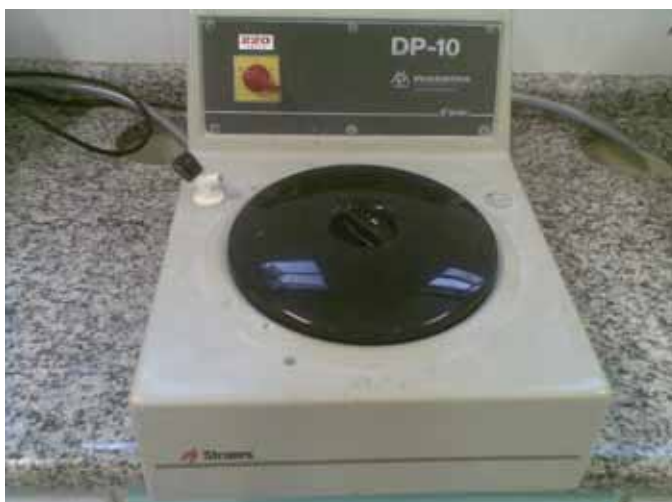
Figura 15 – Politriz utilizada na preparação das amostras.
