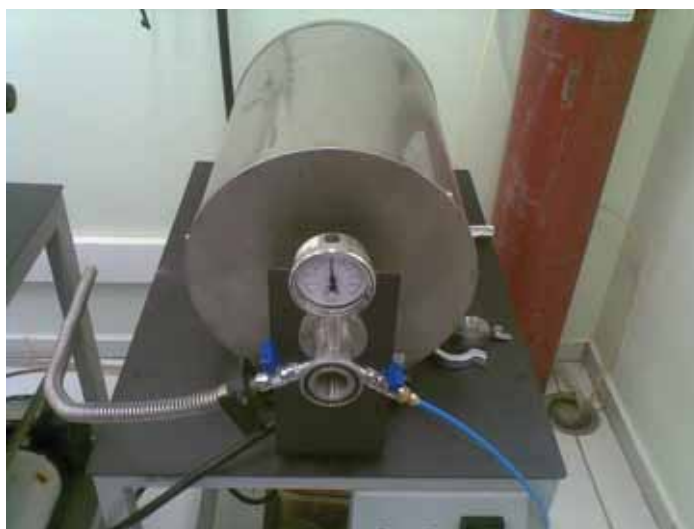
Figura 9 – Forno tipo mufla utilizado para a realização dos tratamentos térmicos.
