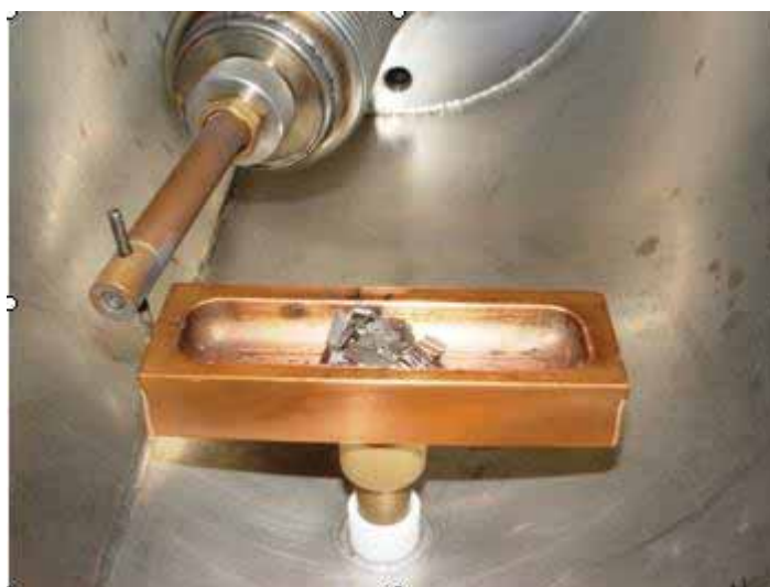
Figura 8 – Disposição das amostras dentro do forno.
