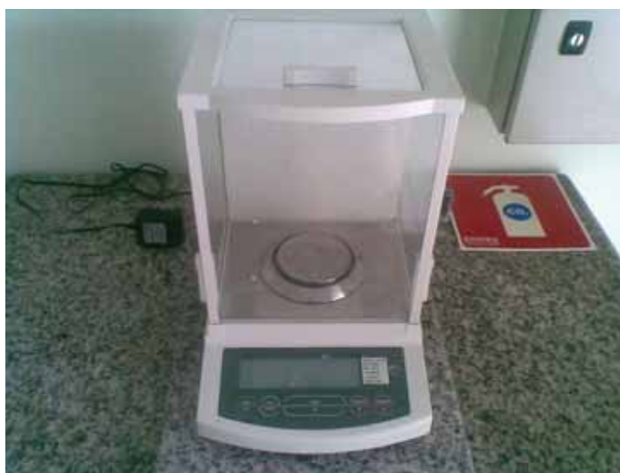
Figura 6- Balança analítica utilizada da medição dos pesos dos constituintes das ligas.
