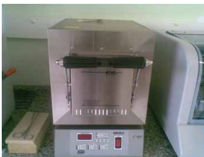
Figura 10 – Forno utilizado para o reaquecimento das amostras.
