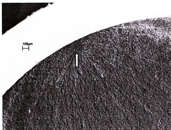
FIGURA 4.14 - Superfície de fratura do CDP 9D.
