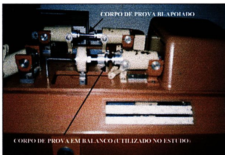
FIGURA 3.7 - Máquina de fadiga por flexão rotativa (Foto cedida por Nascimento [141]).
