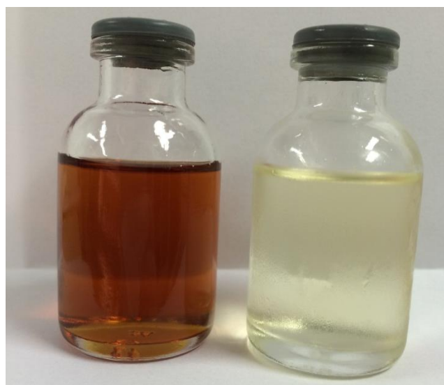
Figura 5.1 - Visualização do Glicerol bruto: (a) sem tratamento e (b) após tratamento ácido
