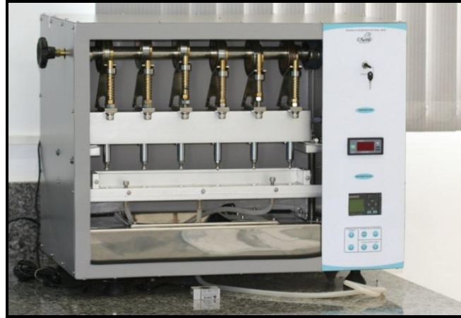
Figura 8 – Vista frontal do equipamento eletromecânico de ensaio de fadiga por mastigação, no qual os corpos-de-prova foram submetidos à ciclagem mecânica.
