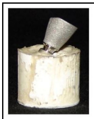
Figura 7 – Corpo-de-prova contendo o implante no interior do cilindro de resina e a coroa parafusada, prontos para aplicação do carregamento (ciclagem mecânica).
