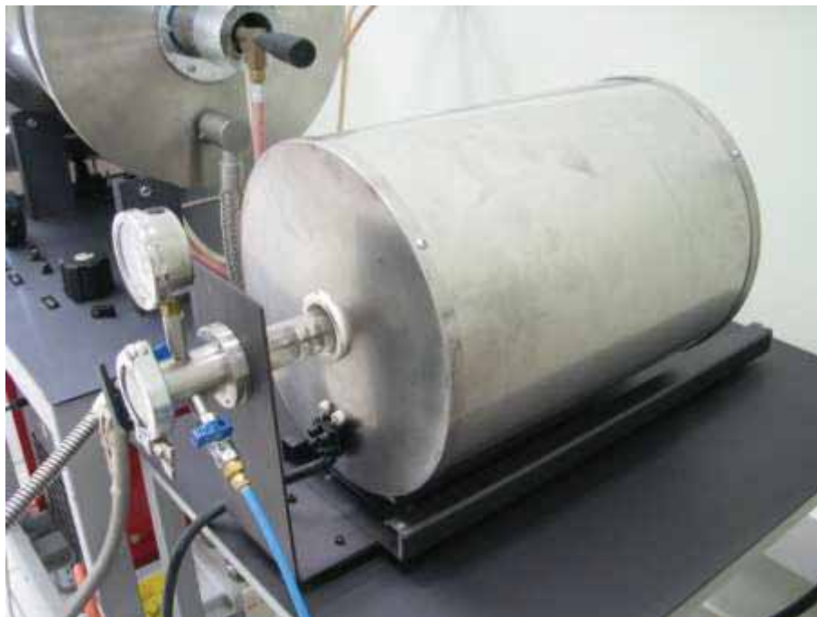
Figura 18- forno de tratamento térmico com atmosfera controlada.
