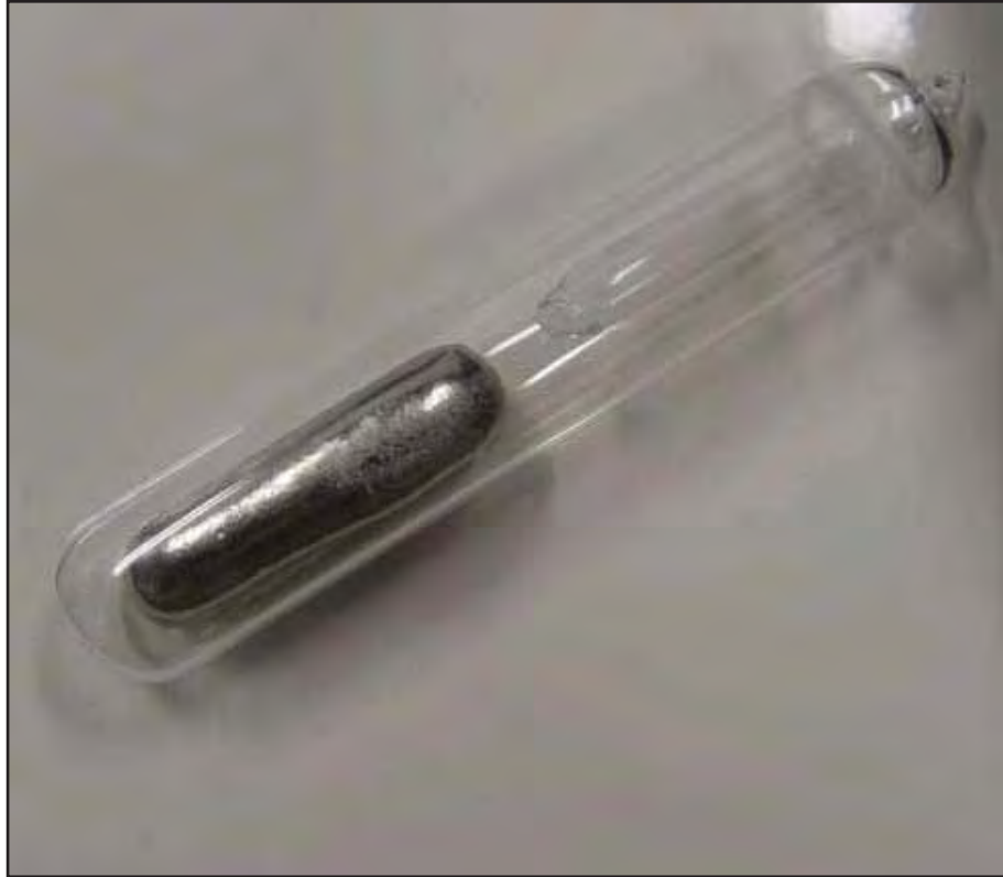
Figura 13 – Detalhe da amostra após encapsulamento à vácuo
