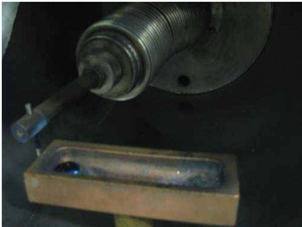
Figura 12- Cadinho de cobre com a liga de Ti fundido.
