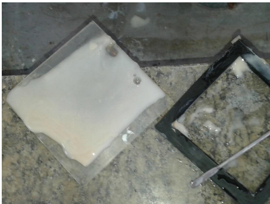
Figura 3.2 - Hidrogel de PMAA-co-PAAm com CMC, zeólita e 2% MBAAm.
