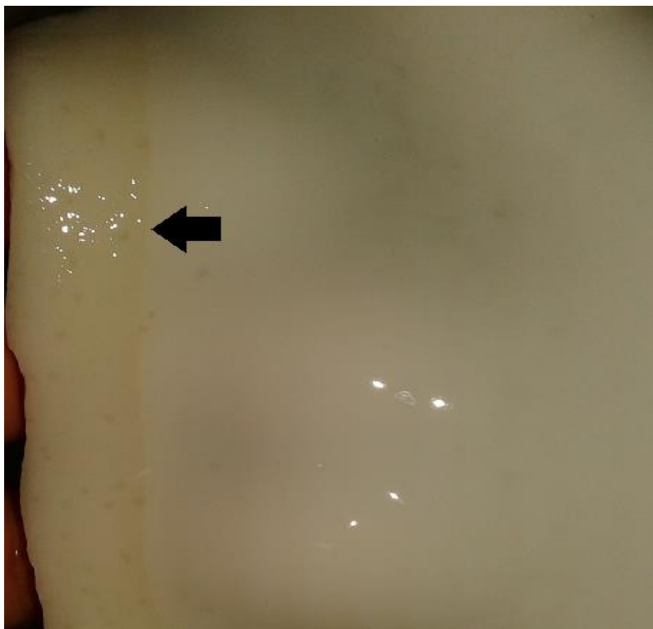
Figura 4.6 - Hidrogel (PMAA-co-PAAm com CMC), e zeólita (2% da massa em relação ao volume) precipitada na região inferior do hidrogel.
