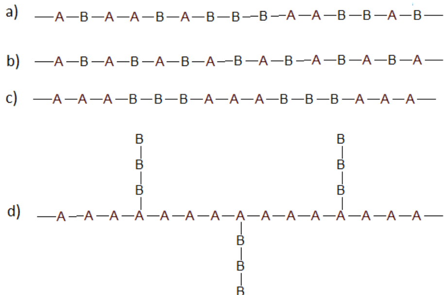
Figura 1.2- Possíveis arranjos de cadeias de copolímeros a) aleatório, b) alternado, c) bloco e d) grafítizado.
