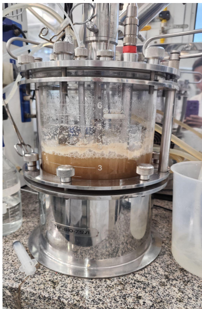
Figura 3 - Cultivo de S. davaonensis em biorreator Tecnal Tec-Bio-Flex em meio AE, por 77 horas.
