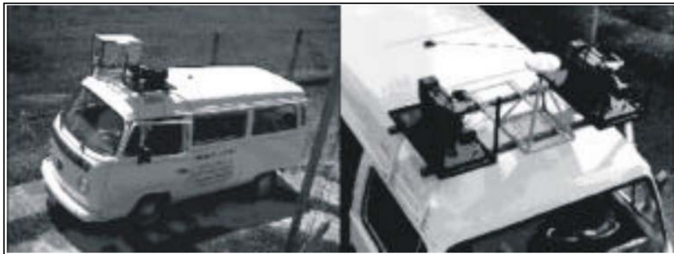
Figura 1 - Protótipo de um veículo de mapeamento móvel terrestre 1
