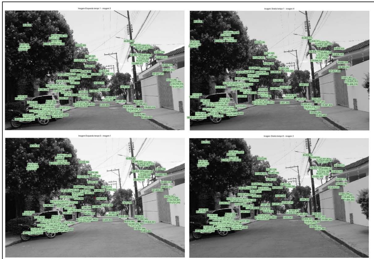
Figura 48 - Demonstrativo gráfico dos pontos-chave nas quatro imagens (60% redução e 0.6 SIFT)
