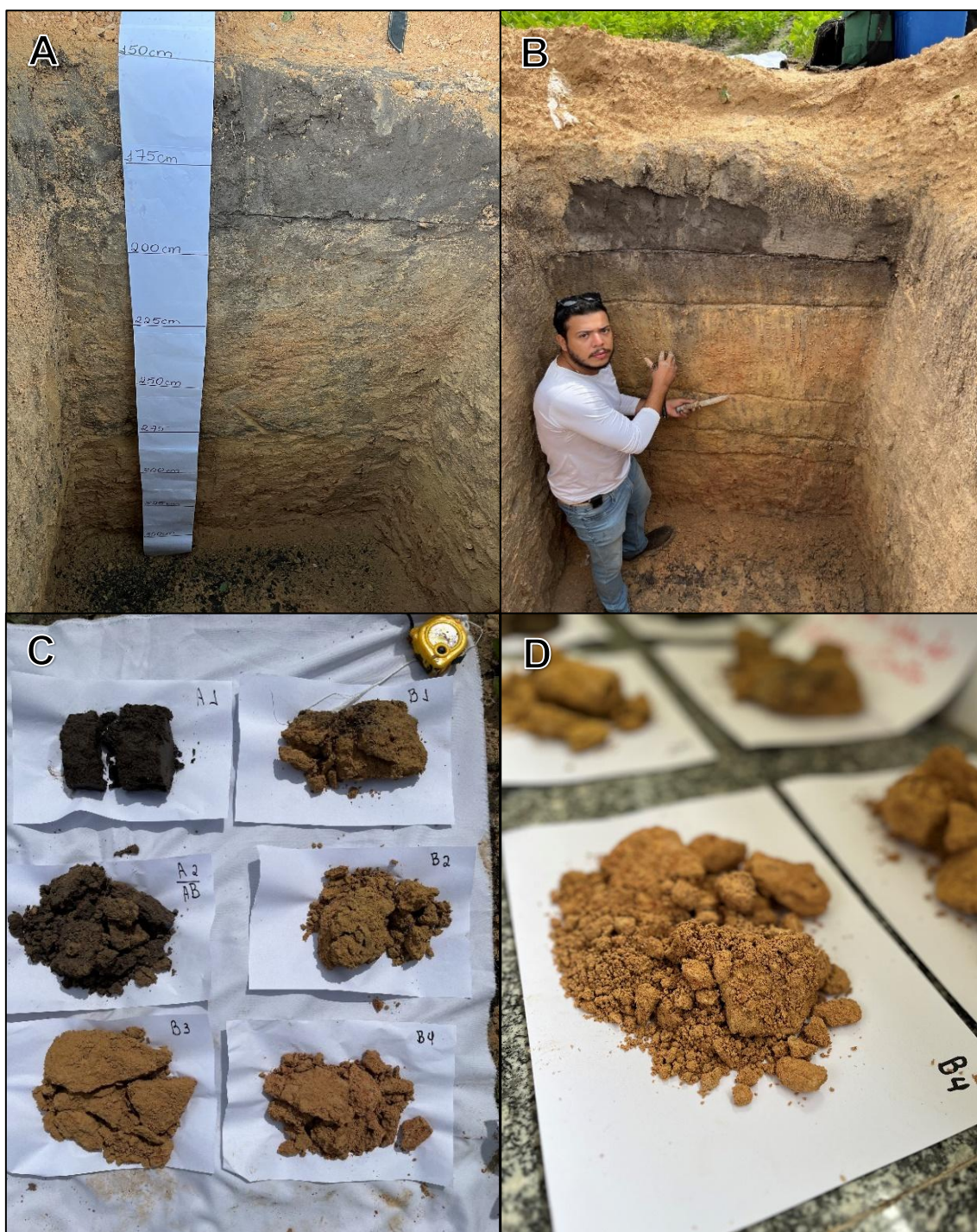
Figura 6. Representação de campo e de laboratório das fases de classificação de solo com abertura de trincheira (2 m de profundidade x 1,5 m 2 ) na área de pasquina, localizada na fazenda Unha de Gato, município de Mata Roma – Maranhão. Figura 6A = Régua graduada de referência para visualização da espessura dos horizontes diagnósticos; Figura 6B = Divisão dos horizontes diagnósticos; Figura 6C = Amostras representativas em campo; Figura 6D = Amostras em bancada para análises físicas.
