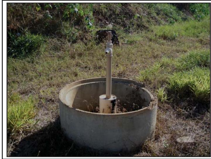
Figura 10. Medidor do teor de chorume no solo.
