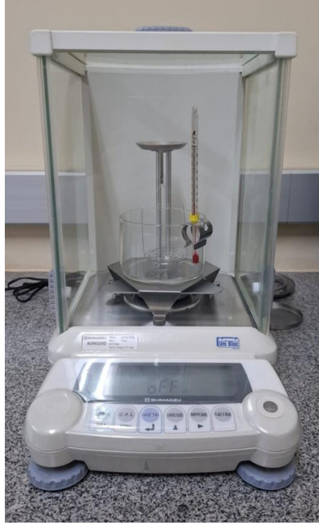
Figura 5 - Balança analítica Shimadzu AUW220D equipada com termômetro e sistema para fazer a medida em ar e em fluido.
