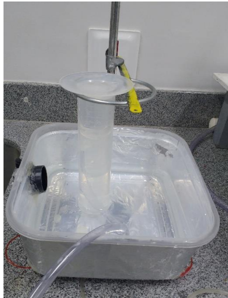
Figura 24 - Medição de dióxido de carbono.
