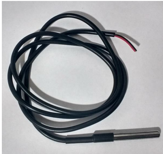
Figura 15 - Sensor DS18B20 para medida de temperatura no fotobiorreator.
