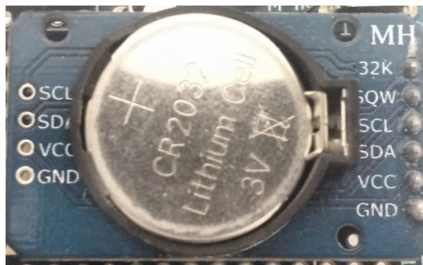
Figura 16 - Sensor DS3231 para medição de temperatura ambiente.
