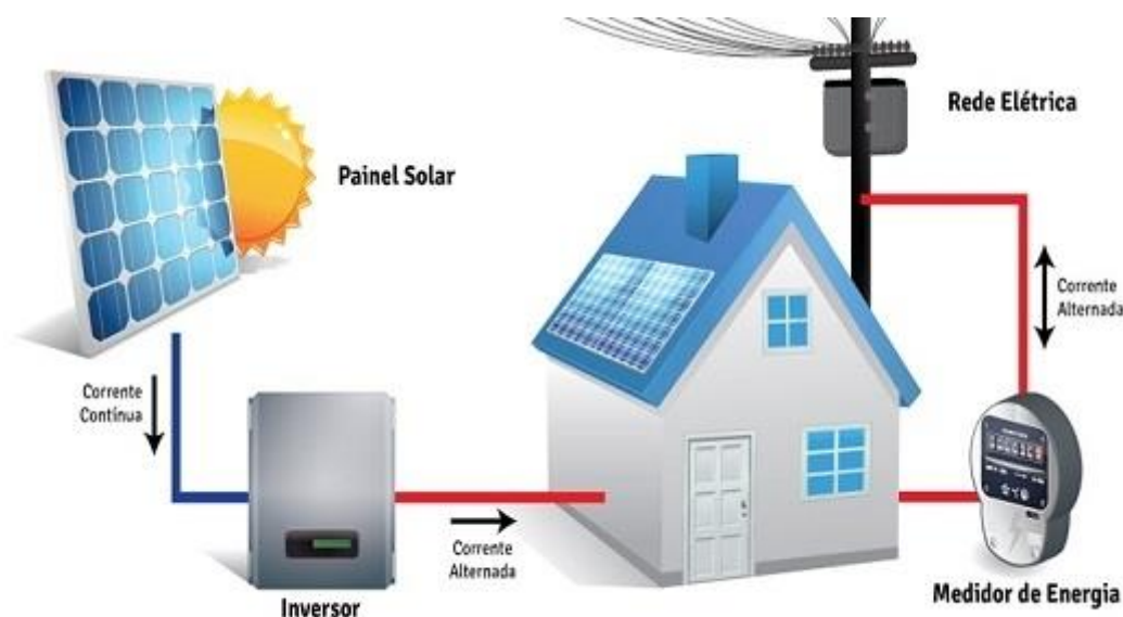
Figura 6 – Sistema Fotovoltaico Conectado à Rede Elétrica
