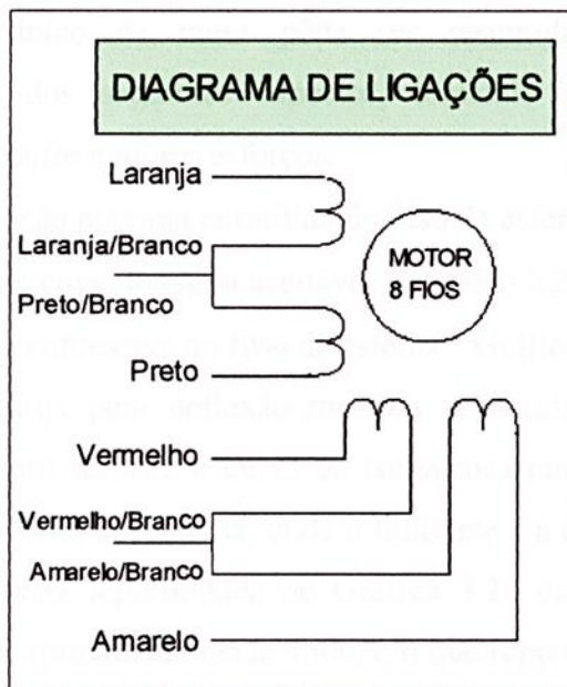
Figura 3.17 – Diagrama de ligações - Motor 8 fios – Catálogo Applied Motion.
