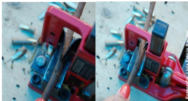
FIGURA 1. Alicate de enxertia utilizado para realização dos tipos de garfagem Fenda esvaziada e Fenda esvaziada invertida. Taquaritinga - SP, 2012.
