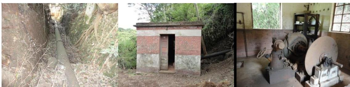
Figura 1.5. Tubulação forçada, casa de máquinas e turbina.
