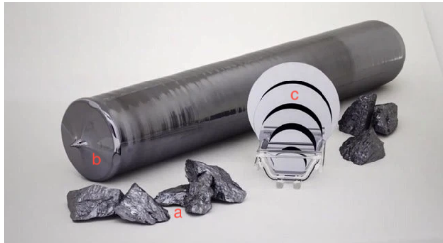
Figura 24 - Silício ultrapuro em formato poroso (a), lingote de silício monocristalino (b) e as lâminas de silício monocristalino (c)
