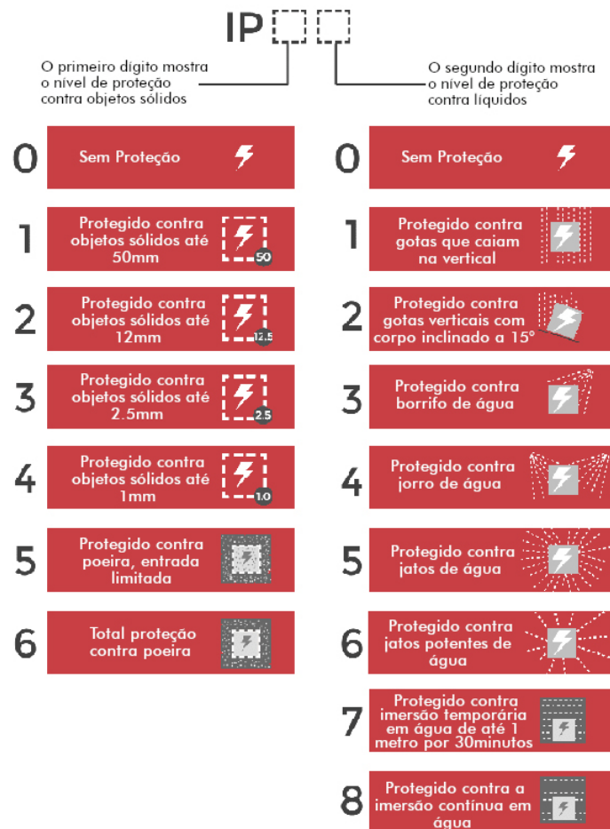
Figura 45 - Esquema para determinação de grau de proteção IP
