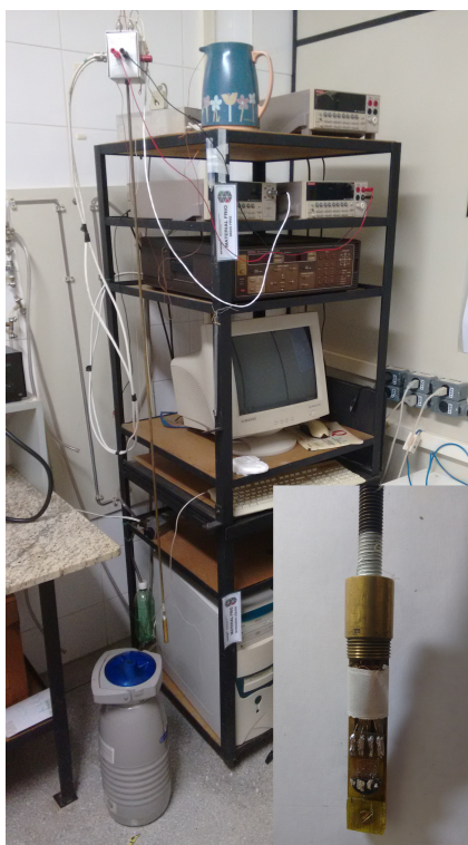
Figura 4.1: Equipamento utilizado para realizar medidas elétricas de quatro terminais.
