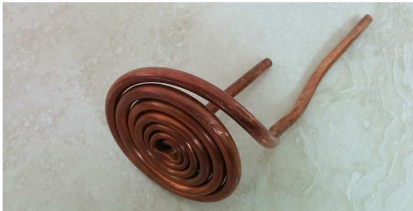
*Figura 25 – Trocador de Calor constituído por um tubo de cobre em formato espiral.*
