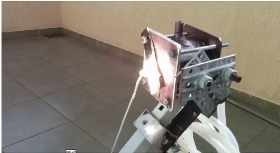
Figura 31 – Absorvedor seco realizando o teste de temperatura de estagnação (17/12/2014).
