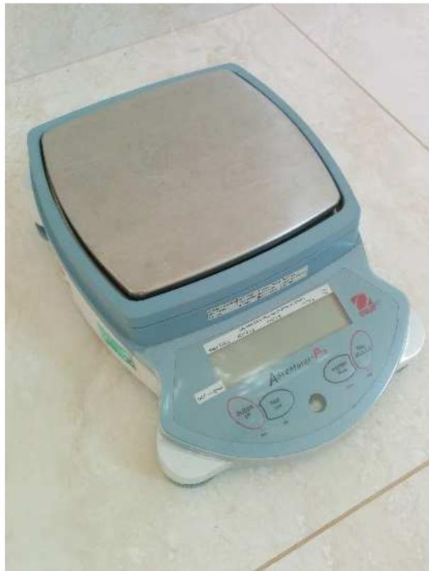
*Figura 24 – Balança de precisão, marca Ohaus, utilizada para medir as massas das amostras de fluido térmico.*
