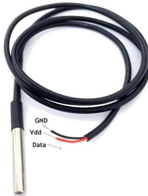
*Figura 21 – Sensor de temperatura DS18B20, fabricado pela Maxim.*
