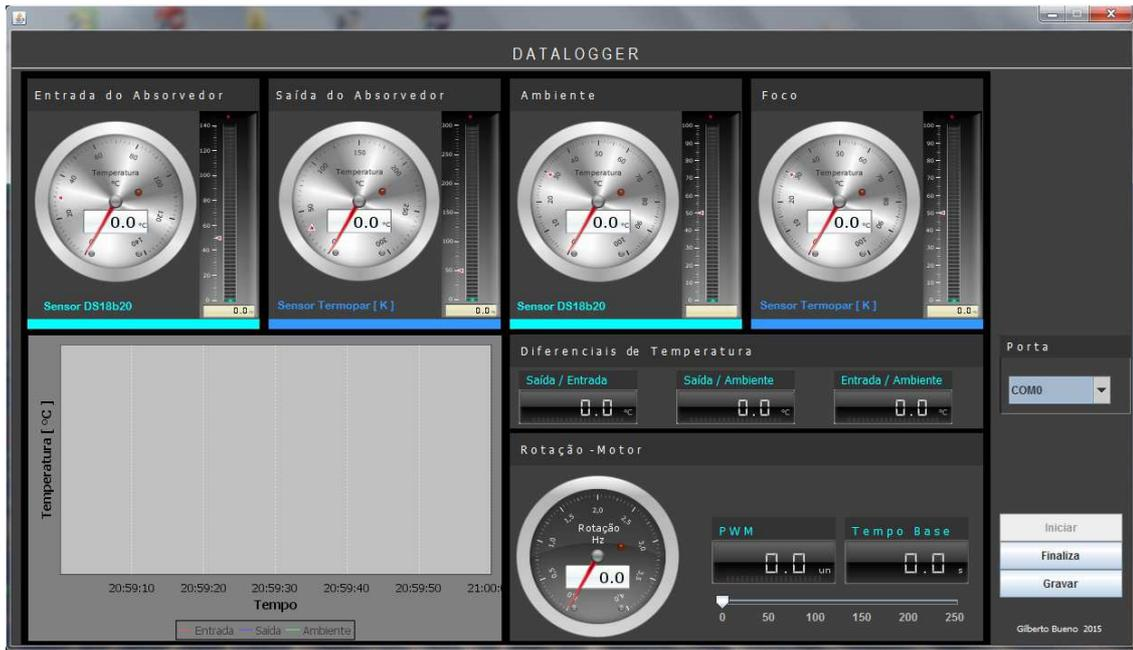
*Figura 29 – Painel de Controle do Experimento (Datalogger). Desenvolvido em linguagem Java.*
