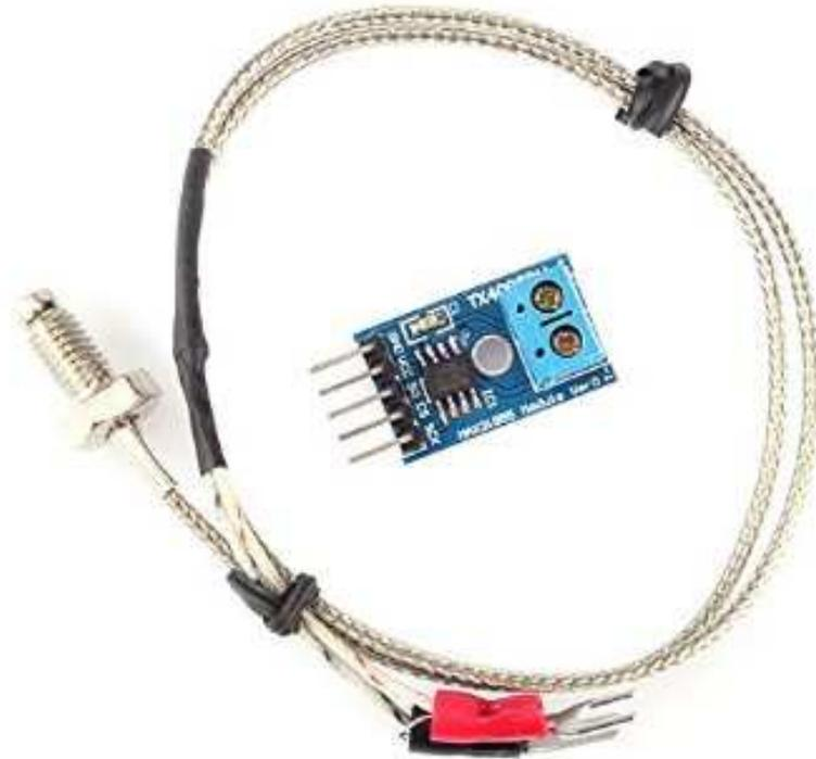
*Figura 22 – Termopar tipo "K" e o módulo MAX6675.*
