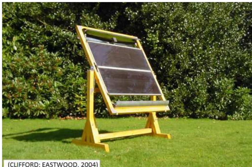
*Figura 5 – Sistema de rastreamento solar passivo utilizando elemento bimetálico.*
