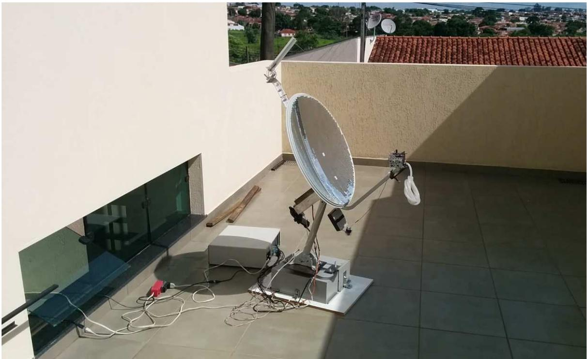
*Figura 30 – Equipamento no momento do teste da temperatura de estagnação (dezembro/2014). Nesta etapa do projeto foi testado o primeiro tipo de absorvedor.*
