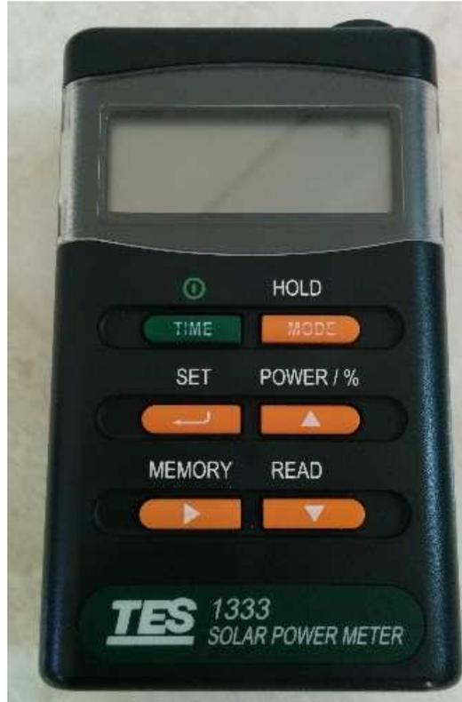
*Figura 23 – Solarímetro (marca TES) utilizado para aquisição da irradiação solar durante o experimento.*
