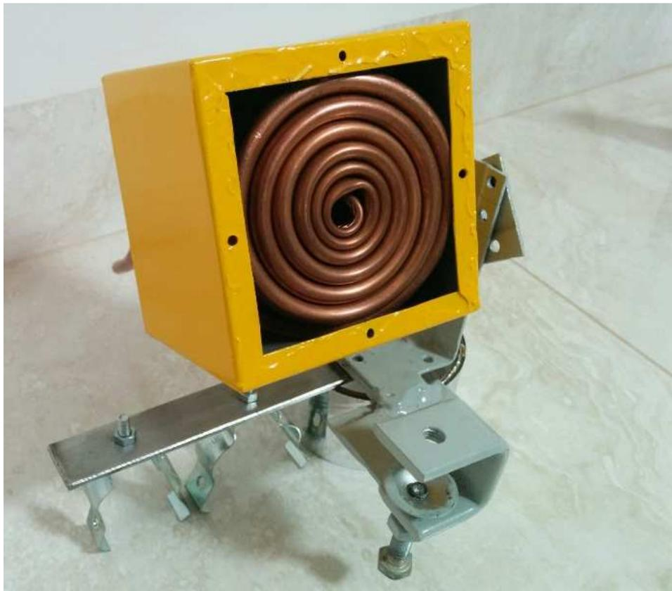
*Figura 26 – Trocador montado em caixa isolada termicamente.*
