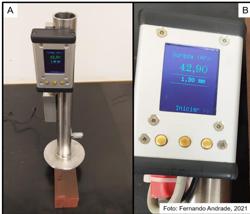
Figura 18 - Ensaio de endentação dinâmica. (A) posicionamento do equipamento e (B) valor de dureza obtido diretamente no painel eletrônico
