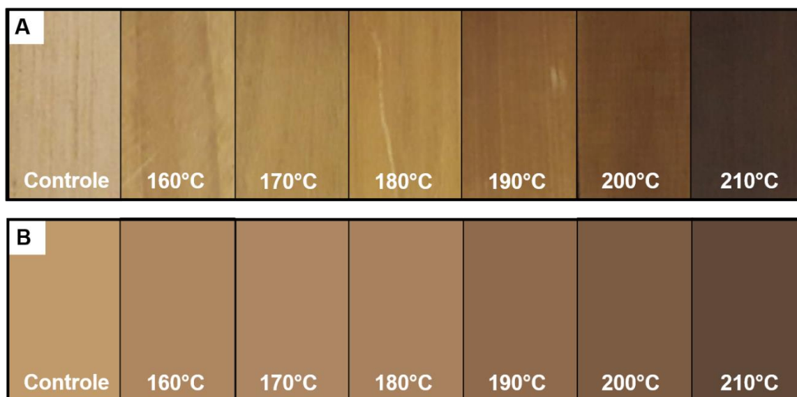
Figura 17 - Mudanças na coloração da madeira de Tauari in natura e modificada termicamente. A: cores reais do controle e da madeira modificada termicamente
