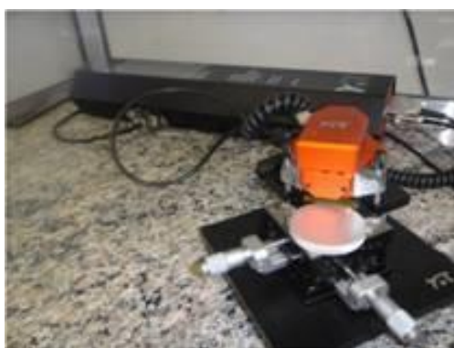
Figura 30 -Microscópio de Força Atômica (AFM) Nanosurf , modelo Easy Scan 2 .
