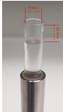
Figura 7.2 – Suporte de amostras para a determinação do \mu -CT.
