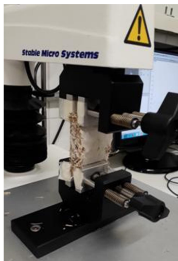
Figura 5.4 – Texturômetro TA.TX Plus para o experimento de resistência do substrato a resistência à tração, utilizando probe Tensile Grips A/TG.
