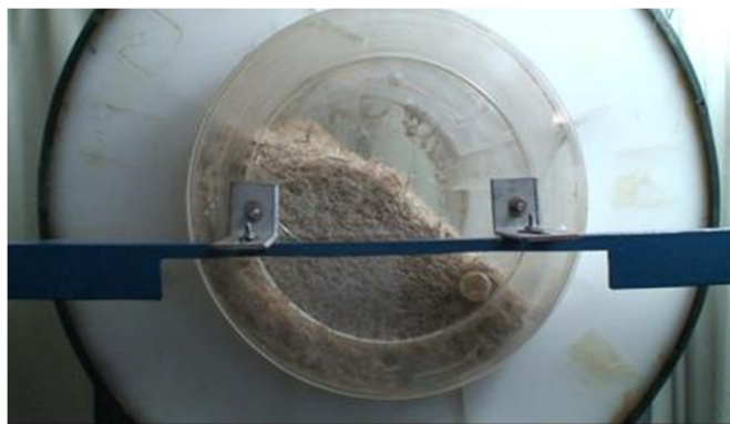
Figura 6.1 – Estrutura do tambor de acrílico utilizado nos ensaios sem cultivo em estado sólido.
