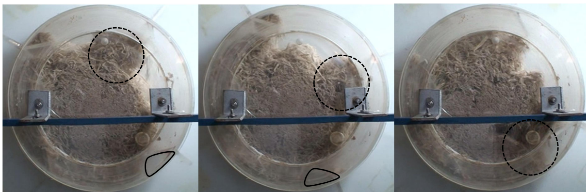
Figura 6.5 – Representação da movimentação da mistura BC:FT com 10% de umidade no tambor de maior diâmetro, com grau de enchimento 0,4 a 8 rpm.
