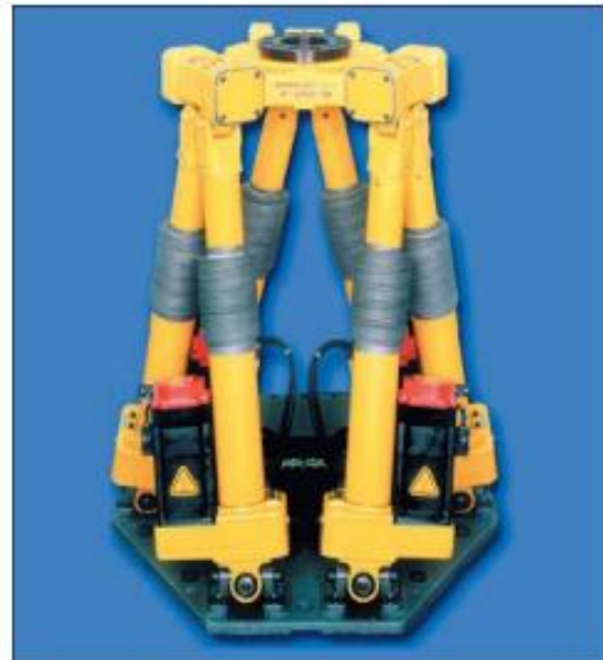
Figura 6 – Manipulador de cadeia cinemática parcialmente fechada (esquerda) e fechada (direita)
