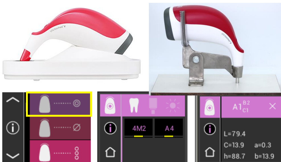
Figura 6 - Imagens ilustrativas do Espectrofotômetro VITA Easyshade® V, dispositivo projetado para padronização da análise, modo utilizado e resultados ilustrativos no visor.
