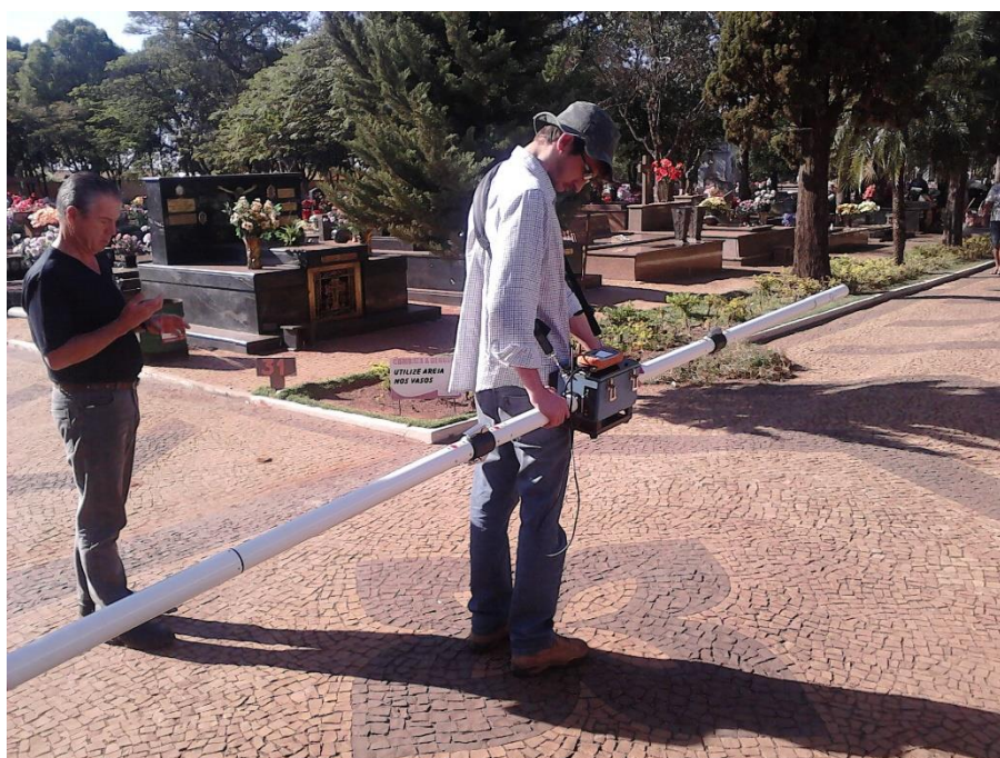
Foto 03: Condutivímetro Geonics EM31-MK2 sendo operado em campo.
