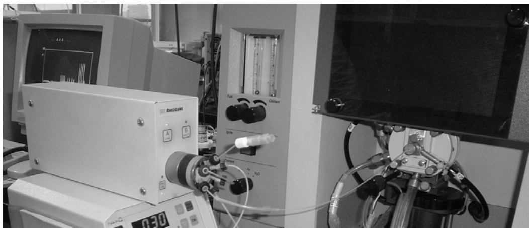
Figura 8: Injeção discreta de amostra através de uma válvula Rheodyne TPMV utilizando o sistema de nebulização pneumática do espectrômetro de absorção atômica 3110 Perkin Elmer.
