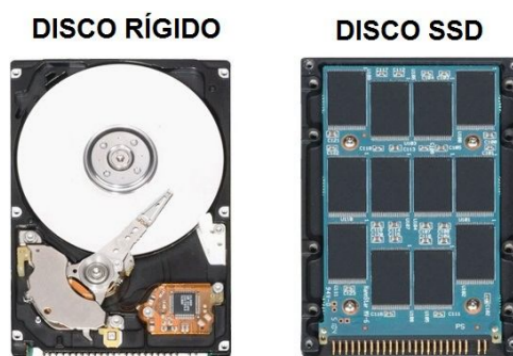
Figura 21 – Comparação entre a estrutura física de um disco HD e disco SSD
