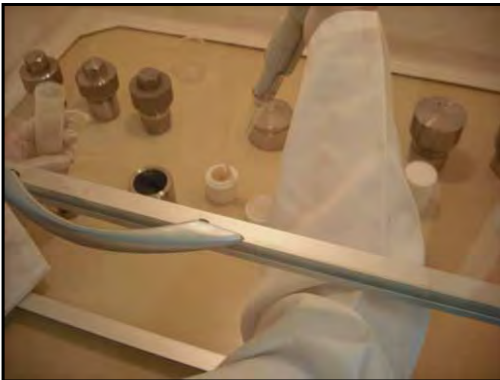
Figura 14. Adição de ácido nítrico na amostra para digestão.
