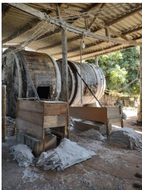
Figura – 13– Fulões utilizados nos curtumes Fonte: Imagem Nilton José Capelozza – Bocaina - SP
