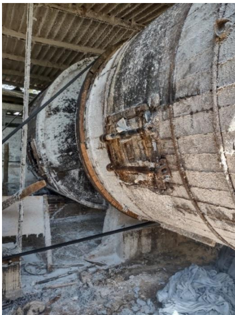
Figura – 12 – Fulões utilizado nos curtumes Fonte: Imagem Nilton José Capelozza – Bocaina – SP
