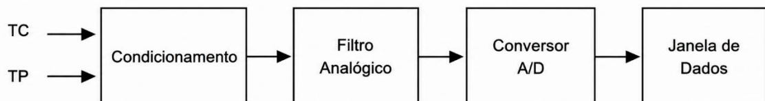
Figura 5 – Diagrama do bloco de aquisição de dados
